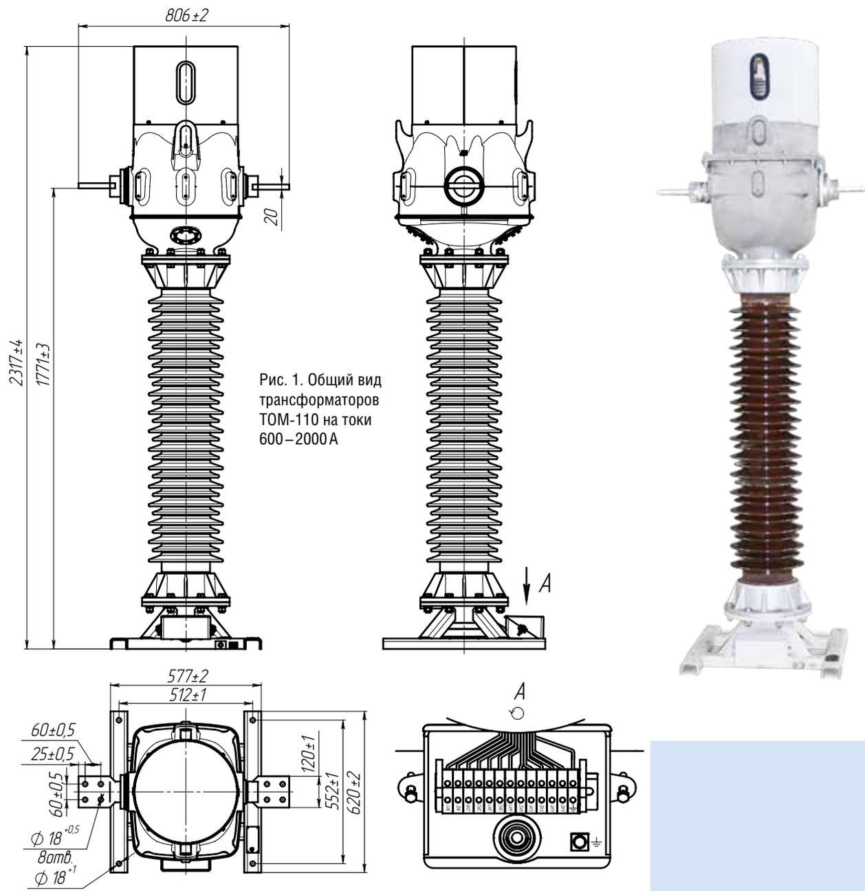
Рис. 1. Общий вид трансформаторов ТОМ-110 на токи 600–2000 А
